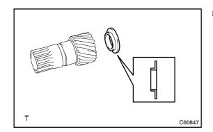
57. REMOVE FRONT PLANETARY FLANGE FRONT THRUST BEARING RACE
