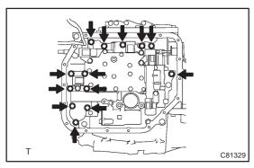
(d) Remove 13 bolts and valve body assy.
