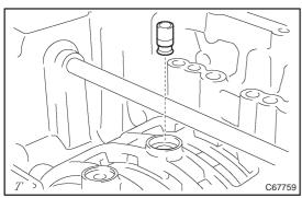
16. REMOVE BRAKE DRUM GASKET [ 35159 / 3503 ]
