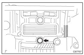
14. REMOVE TRANSAXLE CASE 2ND BRAKE GASKET [ 35149B / 3503 ]
